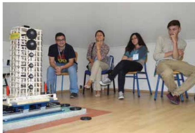
Најуспешниот „Balsa wood“ модел на 12-катна конструкција со базна изолација
